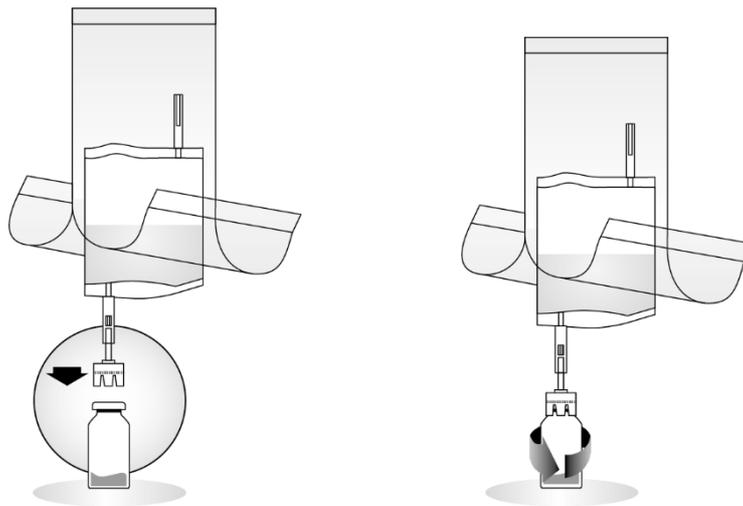
4. Mechanismus im Schlauchteil des Durchstechflaschen-Anschlusses durch wiederholtes Rückwärts- und Vorwärtsknicken aufbrechen. So wird eine Verbindung hergestellt. Während des Vorgangs bitte den Schlauchteil und nicht die Durchstechflasche festhalten!
